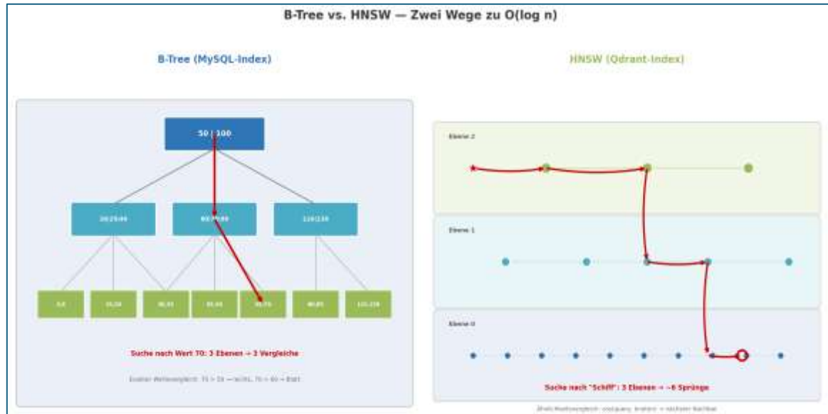
Abbildung 5: B-Tree vs. HNSW – gleiche Komplexität, unterschiedliche Datentypen und Vergleichsoperationen.
